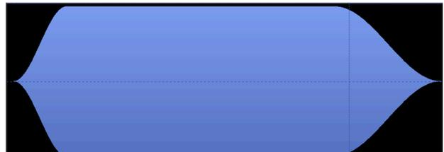
**Figure 1.** Exemple d'enveloppe temporelle d'un grain : une attaque sinusoidale de 10 ms, un maintien de 50 ms, et une chute de 20 ms
